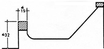
Die tierseitige **Krippenwand** darf inklusive Krippenholz und allfälligen darüber angebrachten massiven Einrichtungen wie Drehrohr für Gruppenauslösung in neu eingerichteten Ställen max. 32 cm und in am 1. September 2008 bestehenden Ställen max. als 34 cm hoch und max. 15 cm dick sein. Gummilappen dürfen die tierseitige Krippenwand über 32 cm/34 cm hinaus erhöhen.
